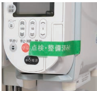
臨床工学科では「点検済テープ」を開発し、使用開始時に必ず使うドアレーに貼付している
