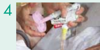
4 チューブを手でおさえ、スクイザーでゆっくり巻き上げて内容物を絞り出す
