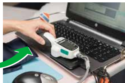
血圧などの測定値が測定した日時とともに電子カルテに送信される
