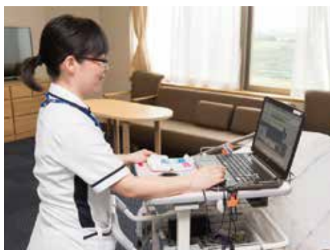
血糖測定機器(メディセーフフィットスマイル)を読取りリーダー(PaSoRi®)にタッチすると、瞬時に測定値を自動的に読み取り、電子カルテに送信される
